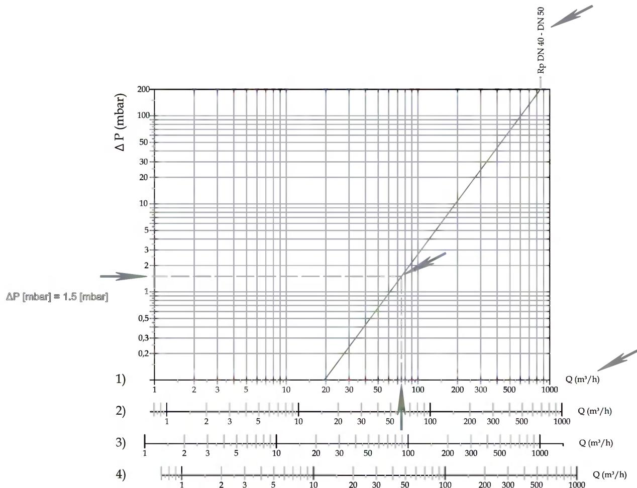
**Діаграма перепаду тиску фільтрація 50 мкм (розрахована при Р1 = 0 мбар)**
