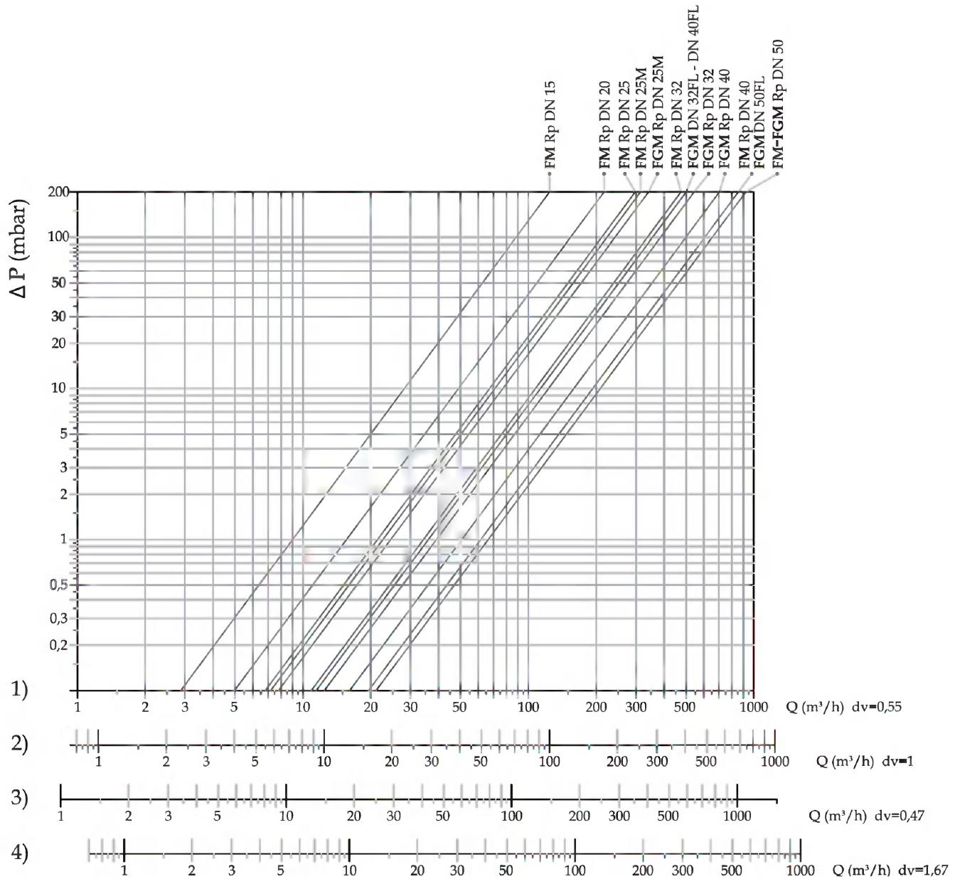
**Діаграма перепаду тиску фільтрація 10 мкм (розрахована при Р1 = 0 мбар)**
