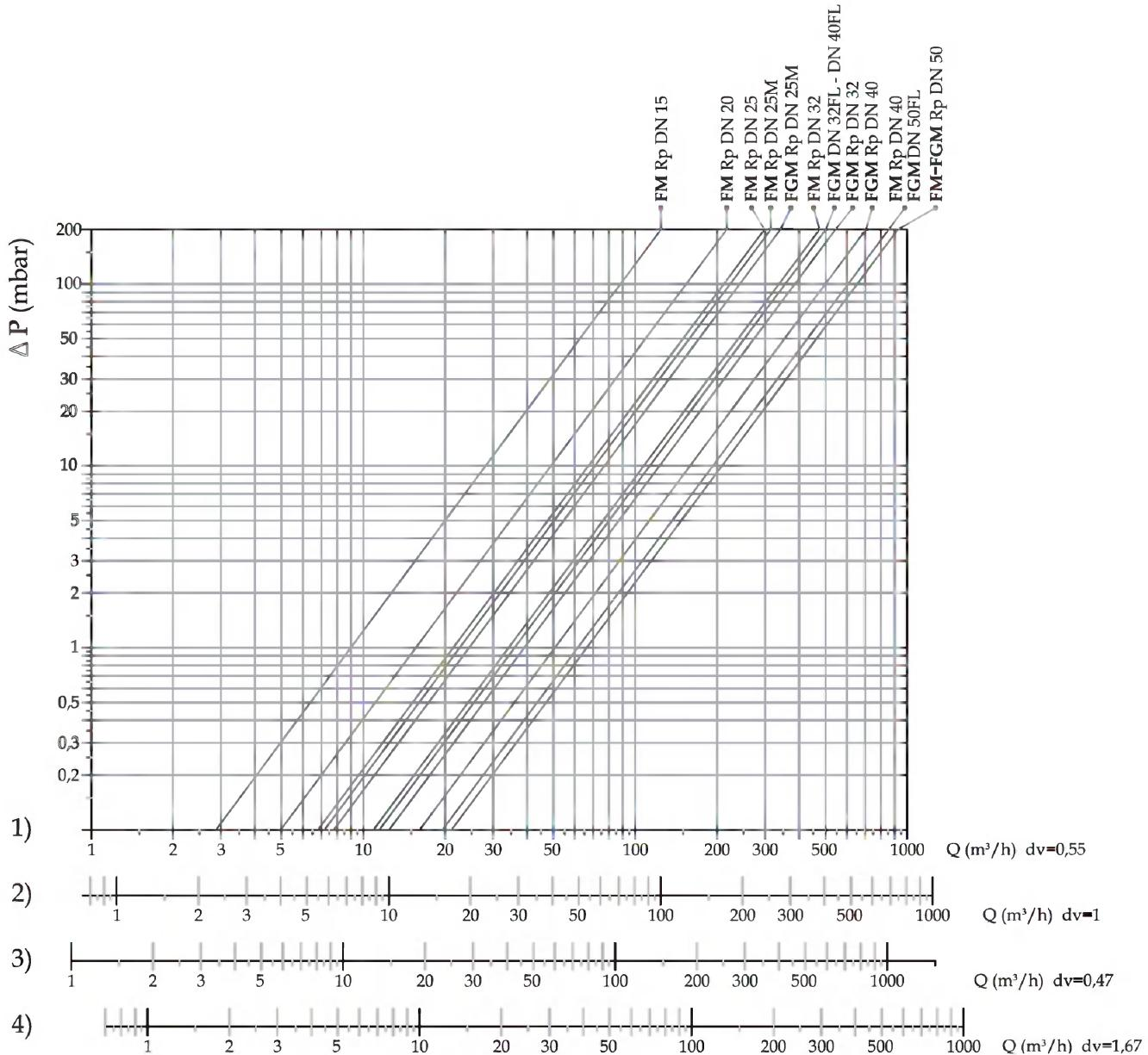
**Діаграма перепаду тиску фільтрація 20 мкм (розрахована при Р1 = 0 мбар)**
