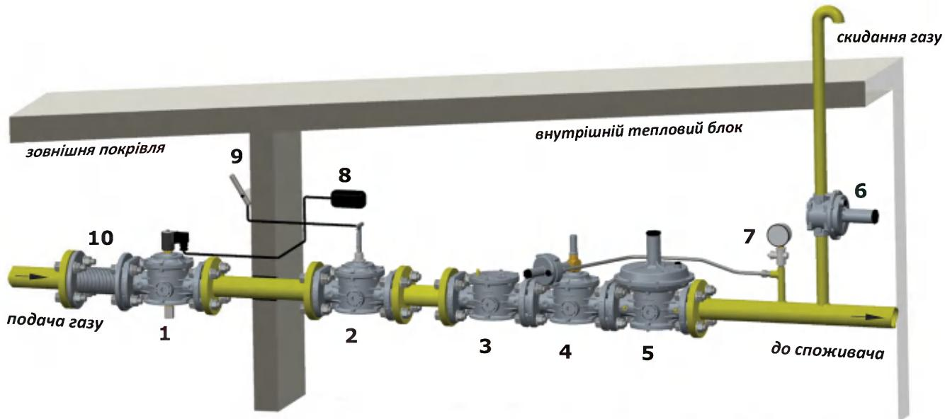
(1) – електромагнітний клапан з ручним зведенням М16/RM N.C.; (2) – дистанційно керований ручний клапан подачі газу SM; (3) – фільтр газовий FM; (4) – запобіжно-запірний клапан по "max." MVB/1 MAX; (5) – регулятор тиску газу RG/2MC; (6) – запобіжно-скідний клапан MVS/1; (7) – манометр; (8) – сигналізатор загазованості; (9) – важіль клапана SM; (10) – компенсаційна вставка;
